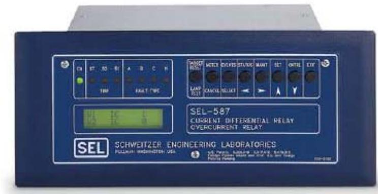
Es importante resaltar que este relé no permite que las entradas de intensidad del lado de AT y del lado de MT sean de distinta intensidad nominal secundaria (5 o 1 A), con lo que es muy importante asegurar que los transformadores de intensidad de ambos lados disponen de intensidades secundarias iguales.
