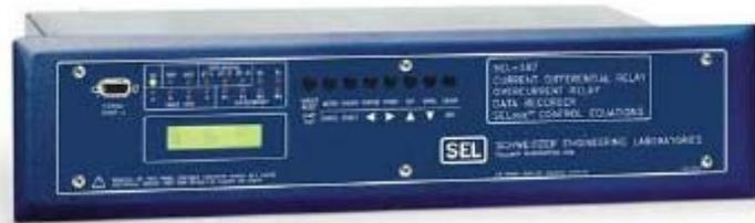
De igual forma que se ha indicado para el caso del relé SEL587 normalizado para trafos AT/MT, este relé no permite que las entradas de intensidad del lado de AT y del lado de MT sean de distinta intensidad nominal secundaria (5 o 1 A), con lo que es muy importante asegurar que los transformadores de intensidad de ambos lados disponen de intensidades secundarias iguales.
